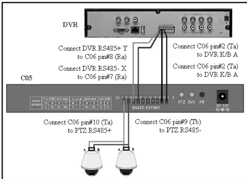
Podrá conectar hasta 32 DVRs, hasta 15 teclados C06 y hasta 256 cámaras PTZ en la misma área donde la distancia de cableado RS485 no supere los 1200 metros.
